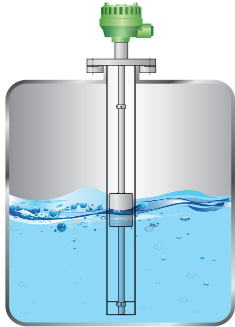
在有流动或喷溅的贮水池中建议使用保护管。
