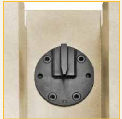
冲击测试配置。试样水平倚靠在夏比支撑上（包覆着保护布）。在前方可以看到夏比对中钳。右图为摆锤。
