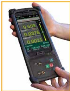
通过蓝牙连接设备的手持无线控制器。该操作界面采用基于安卓操作平台，可用于单独控制设备，或结合Tinius Olsen的Horizon软件进行控制。
